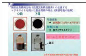
嫌気性集積微生物の生産するマグネタイトを用いた重金属類の除去
