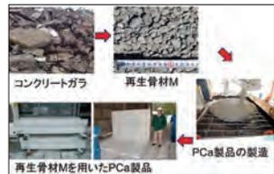
③コンクリートガラから再生骨材Mを製造し、それを用いたPCa製品を製造する技術
