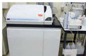
ICP-MS測定装置 質量分析装置により、カドミウムを一個づつカウントするために極めて高感度である
