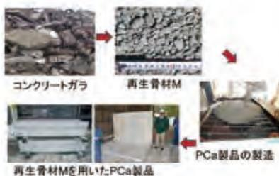
コンクリートガラから再生骨材Mを製造し、それを用いたPCa製品を製造する技術
