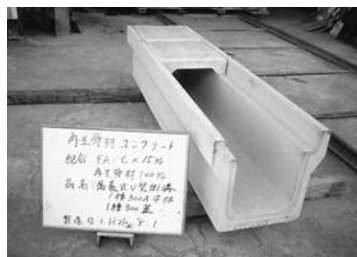
RMPC研究会で開発した再生コンクリート
