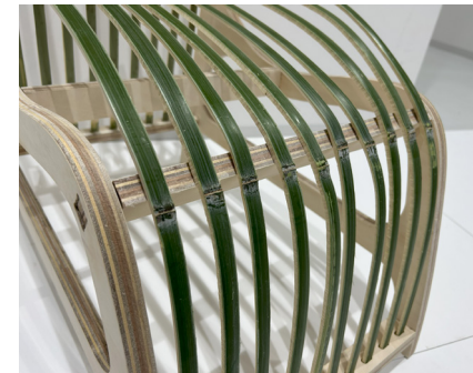
竹のラインを垂直から水平にするために木の構造体で受けて曲げている
