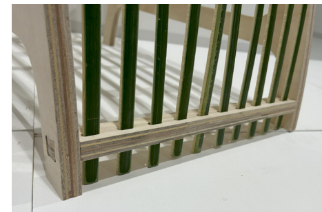
末端部は構造体に穴をあけ貫通させている
