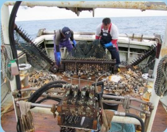
※マンガンとは底引き網漁に使われる約50kgの網です。先端に爪がついており海底をかきまします。
